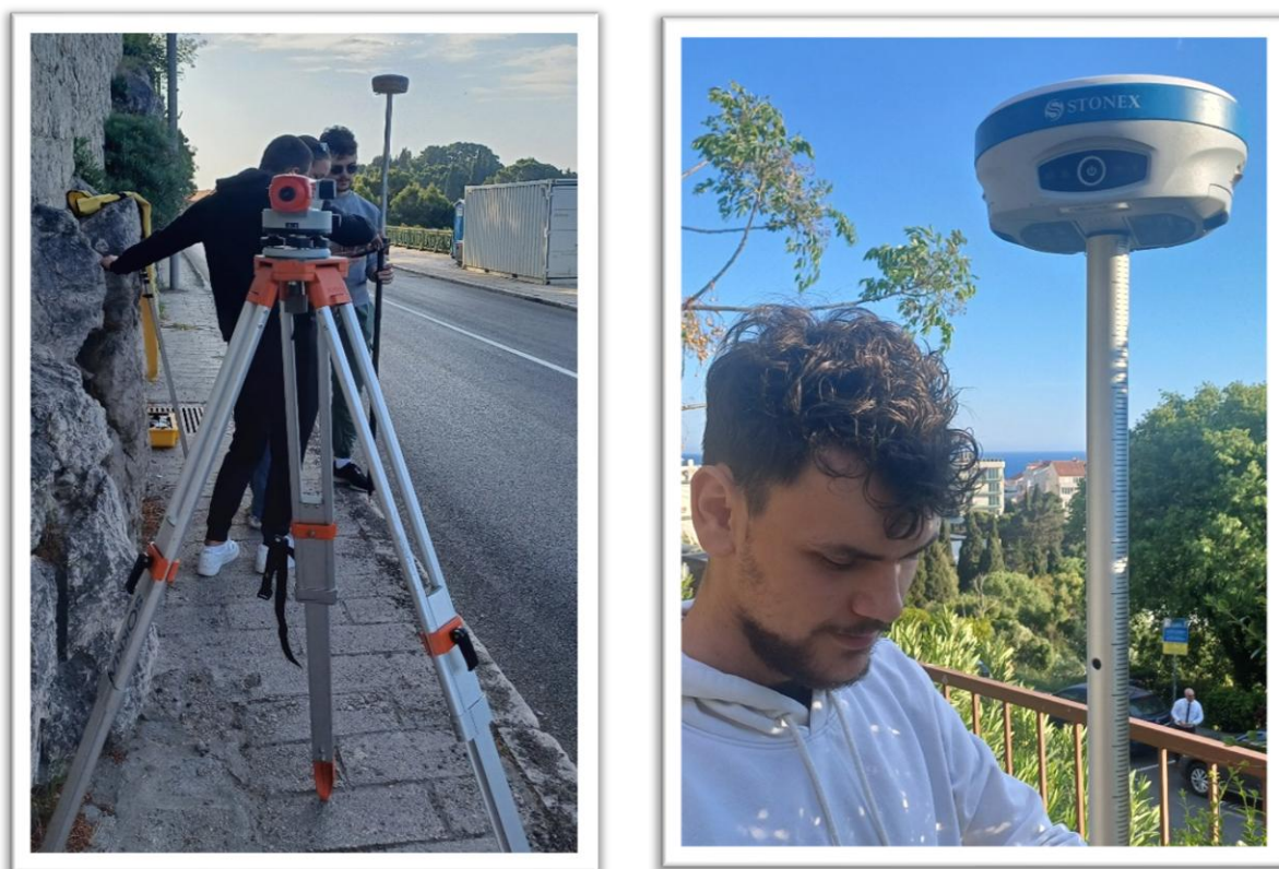
Slika 57 - oprema: nivelir, stativ, letva i GPS
